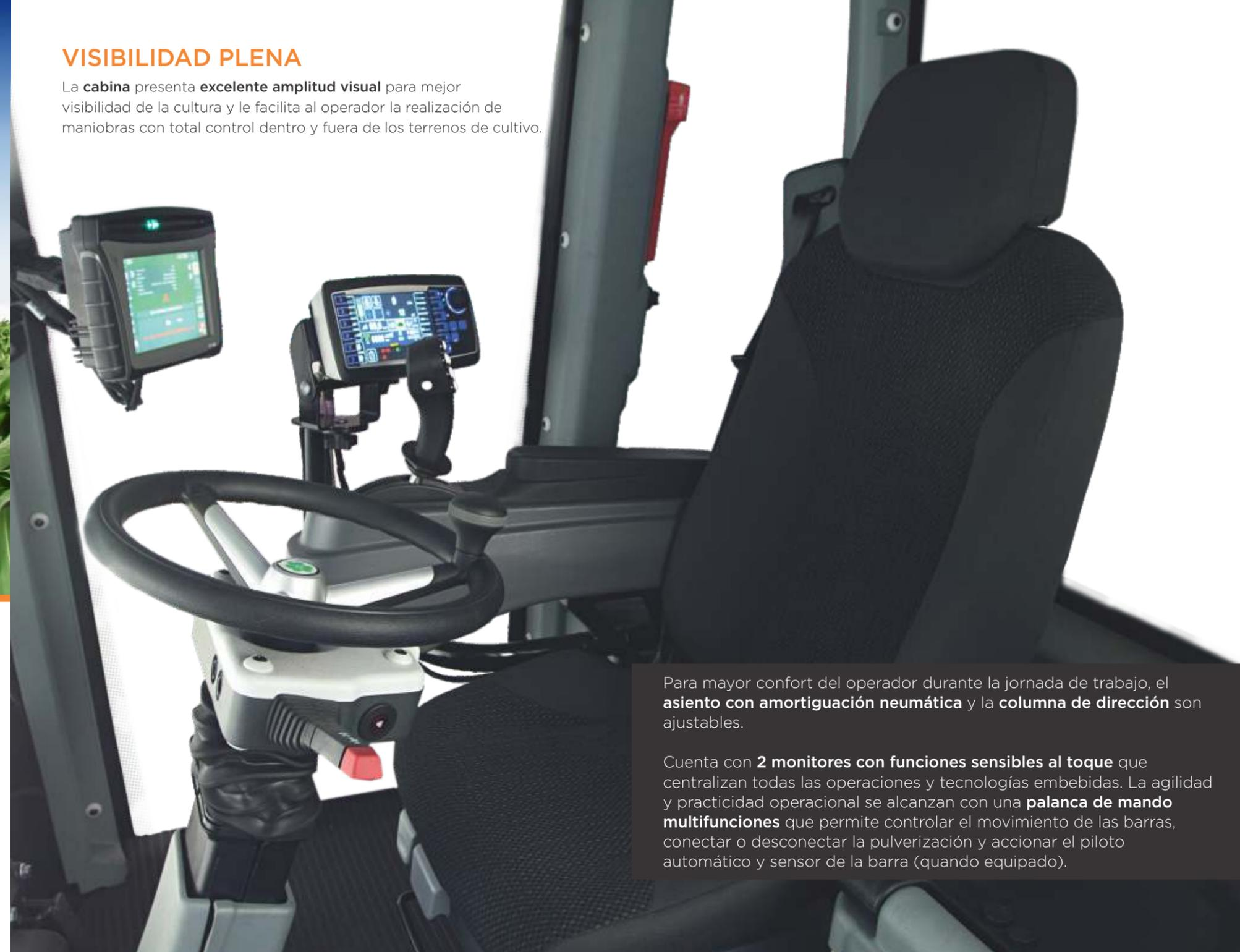
Para mayor confort del operador durante la jornada de trabajo, el asiento con amortiguación neumática y la columna de dirección son ajustables.
